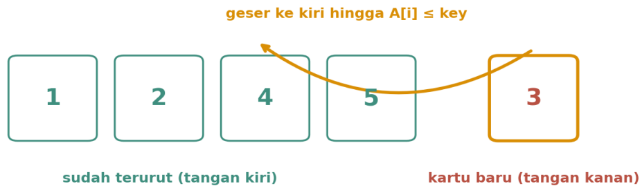
Gambar 2.4 — Intuisi fisik di balik Insertion Sort: kartu baru digeser ke kiri hingga menemukan tempatnya yang benar di antara kartu-kartu yang sudah terurut.
