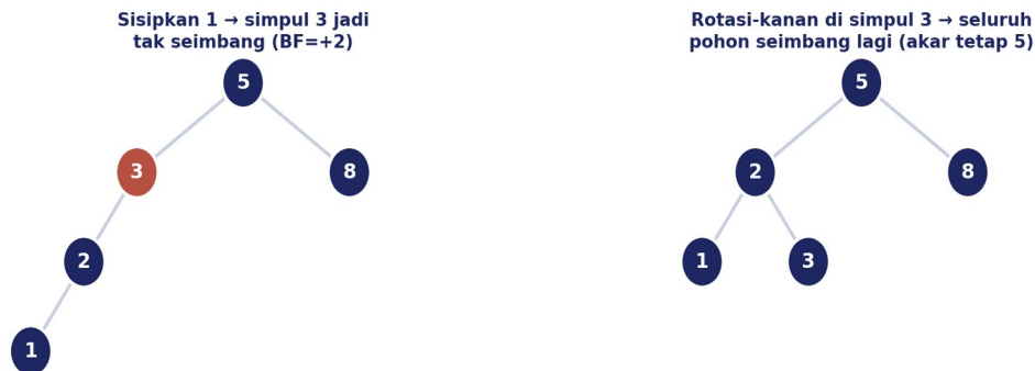
Gambar 6.7 — Menyisipkan 1 ke pohon 4-simpul seimbang {5, 3, 8, 2} membuat simpul 3 tak seimbang (faktor keseimbangan menjadi +2) — dua level di atas daun baru, bukan akarnya. Satu rotasi kanan tunggal di simpul 3 memulihkan keseimbangan ke seluruh pohon dalam satu langkah O(1) ; akar (5) dan subpohon kanannya (8) tidak pernah berpindah, dan faktor keseimbangan akar sendiri turut pulih sebagai efek samping.
